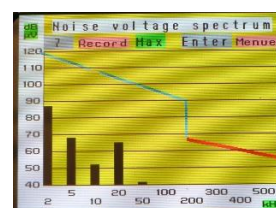
Støykilde innkoppet og nøytralisert med støyfilter.
